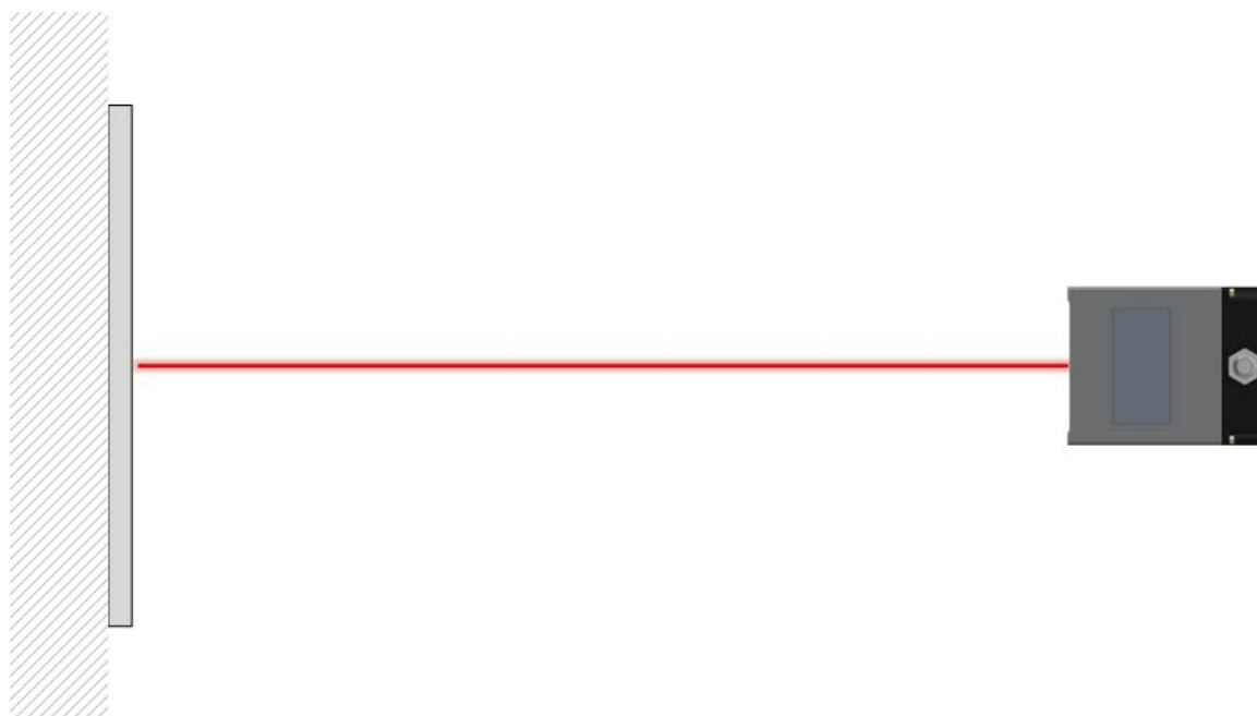
图 4.3: 激光测距传感器及反射板安装示意
